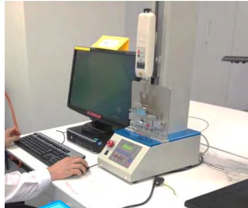
剥離試験機で圧着の度合いをチェック
